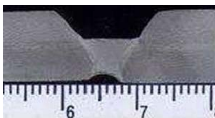
Figura 1. Indicação da falta de metal de adição na raiz. Passe de raiz executado na posição sobre cabeça com arame tubular E71T-1 do fabricante C.
