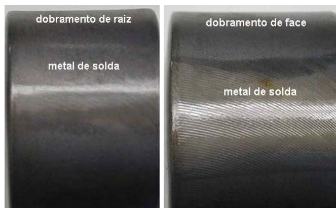
Figura 6. Resultado dos ensaios de dobramento da soldagem manual em tubos realizada na posição sobre cabeça.
