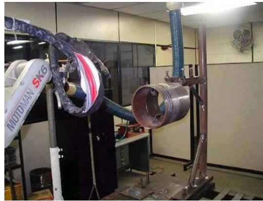
Figura 7. Tubo posicionado para soldagem com o robô antropomórfico.
