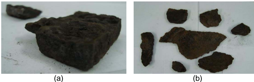
Figura 2. Aspecto da amostra de cascão solidificado no revestimento refratário da parede lateral do cadinho do Alto-Forno 2. (a) parede lateral do cadinho (região a 90° dos furos de gusa); e (b) soleira próxima a região entre os furos de gusa
