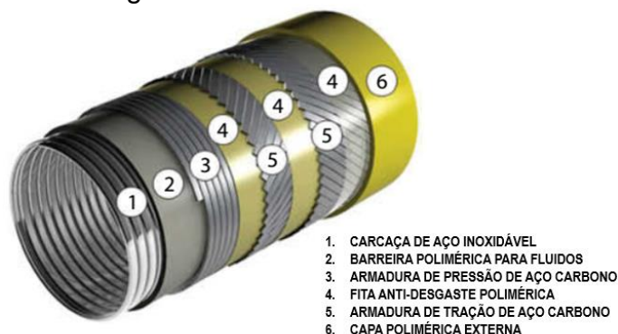
Figura 1. Seção com componentes de riser e umbilical de camadas não aderentes. [4]
