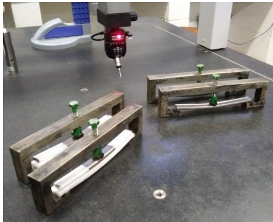
Figura 3. Disposição dos corpos de prova após aplicação de flecha.
