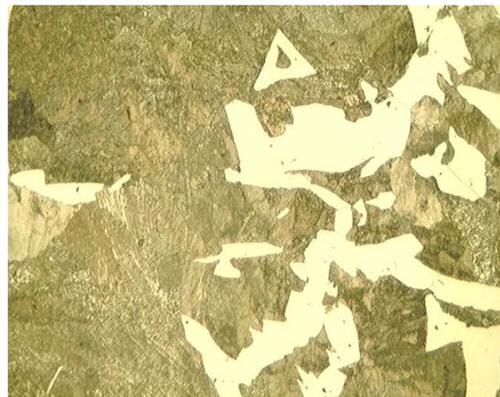
**Figura 6.** Aço II, ataque Nital 2%. Aumento de 250x. Tratamento térmico de normalização.
