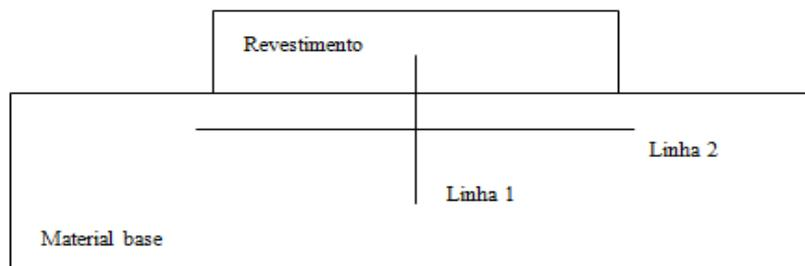
**Figura 2.** Diagrama esquemático dos perfis de microdureza.
