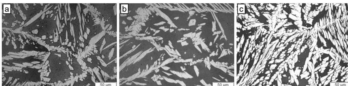
**Figura 2.** Microestrutura da região fundida. a) sem tratamento térmico; b) com resfriamento; c) com tratamento térmico de indução.
