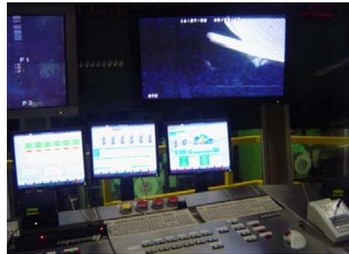
**Figura 7.** Foto da sala de operação do trem acabador, mostrando em destaque a nova câmera para Visualização da Ponta do esboço e inserção dos pinos retentores do Coil Box.
