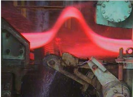
**Figura 4.** Ondulação mostrada através do sistema de monitoramento e gravação digital implantado no LTQ para identificação e análise das sucatas e anomalias de processo.
