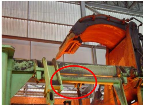
**Figura 6.** Foto do Peeler arm do Coil Box do LTQ. Em destaque a mudança feita da faca do Peeler.
