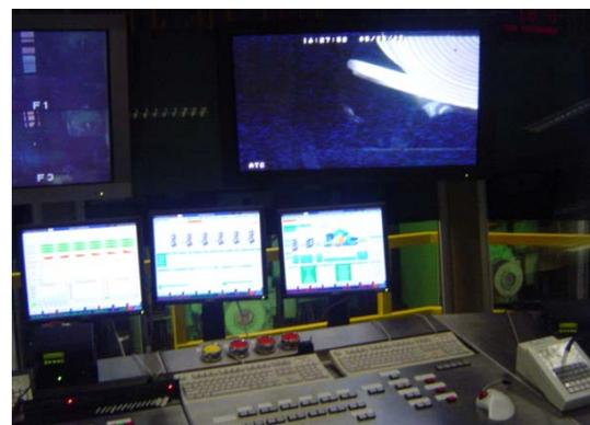
**Figura 7** - Foto da sala de operação do trem acabador, mostrando (no alto, à direita) a nova câmera para visualização da ponta do esboço e inserção dos pinos retentores do Coil Box.
