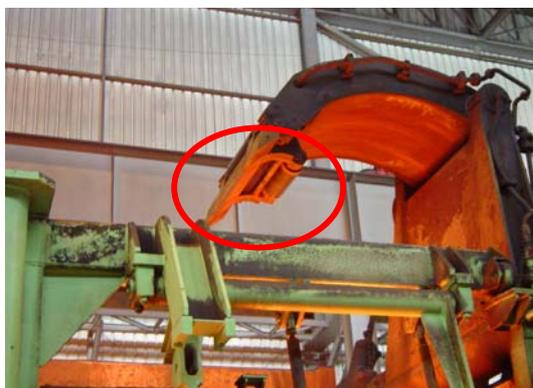
**Figura 6** - Foto do *Peeler Arm* do Coil Box do LTQ. Em destaque nova configuração implantada na "faca" do *Peeler*.
