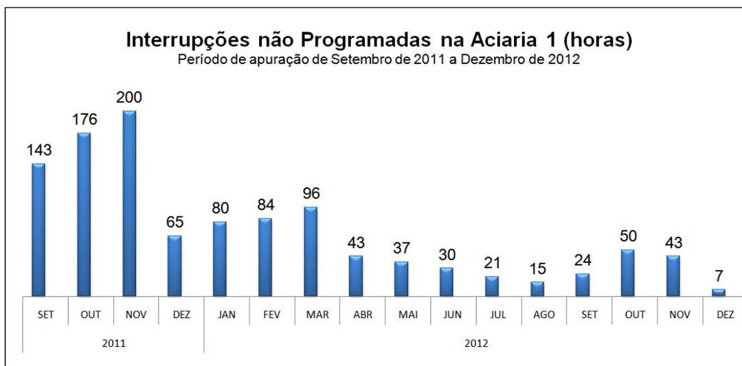
**Figura 7** – Evolução das interrupções não programadas na Máquina de Lingotamento Contínuo nº 4.
