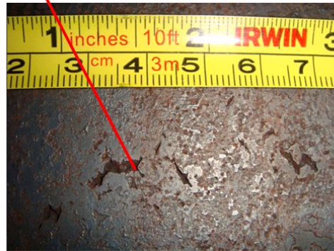
Figura 4 – Caracterização do defeito cavidade.
