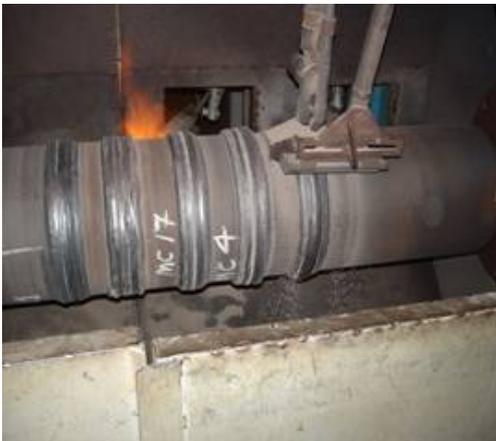
**Figura 19.** Soldagem das amostras sobre o Rolo Teste para execução de testes atuais.
