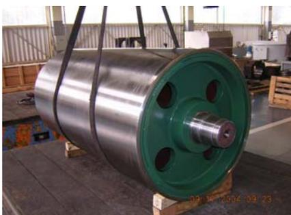
**Figura 4.** Rolo Puxador revestido na mesa, com processo a Arco Submerso.
