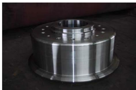
**Figura 5.** Cilindro de Borda revestido na mesa, com processo a Arco Submerso.
