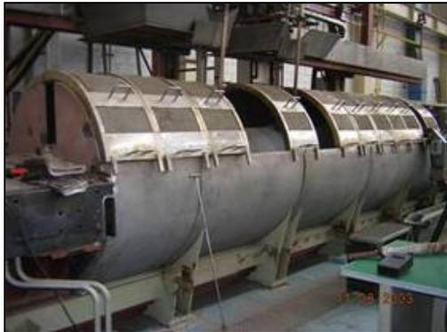
**Figura 1.** Torno de soldagem a Arco Submerso, com câmara de controle de temperatura.
