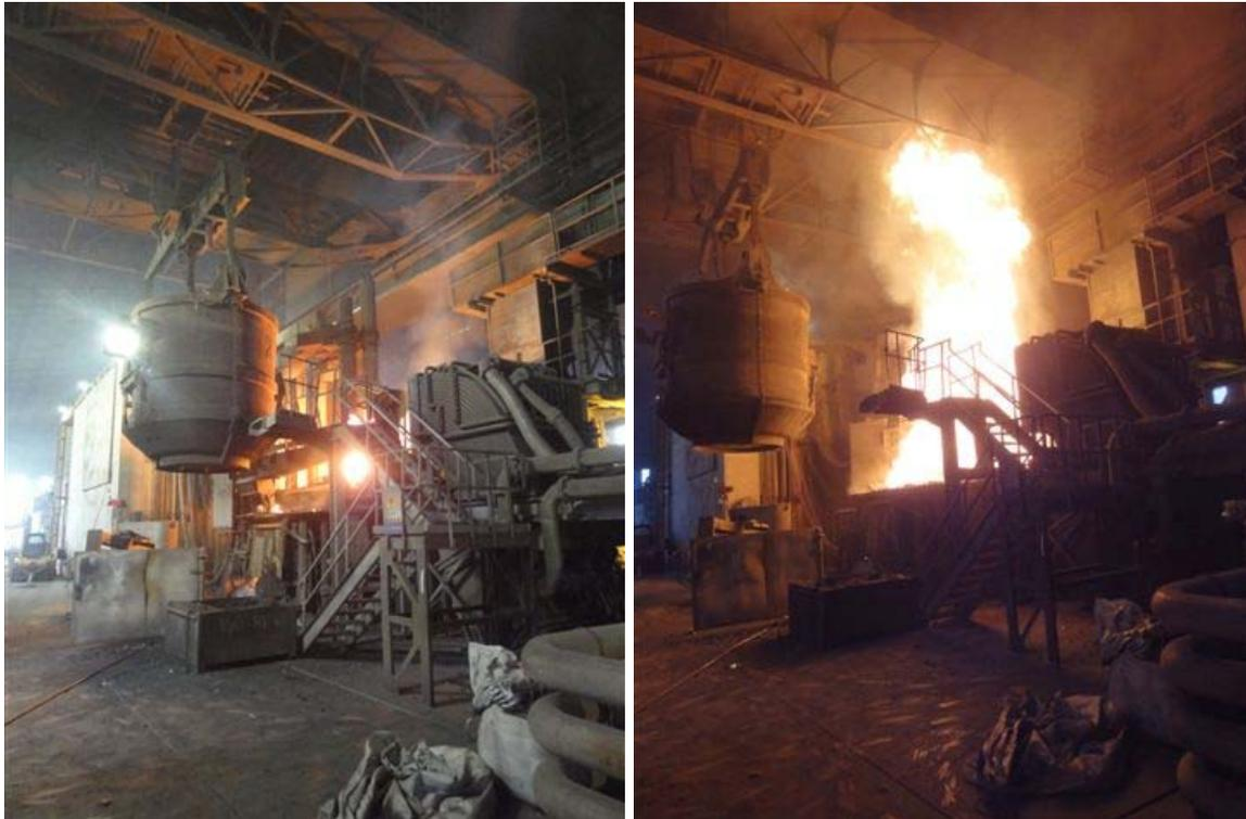
Figura 5. Carregamento do forno.
