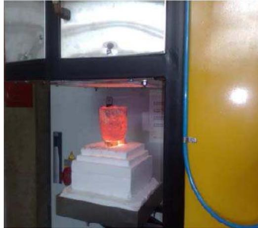
**Figura 1.** Forno usado no tratamento térmico das pelotas.
