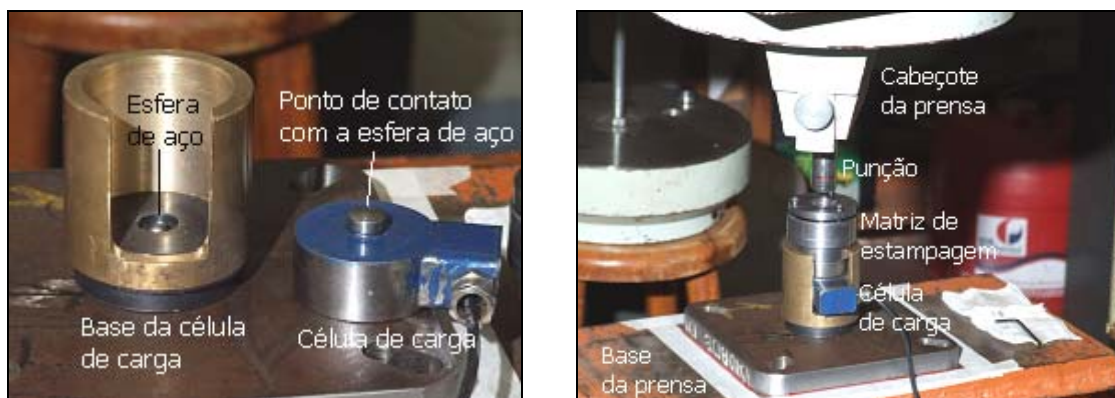
Figura 3. Fotografias ilustrativas no posicionamento da matriz na célula de carga durante a operação de conformação.
