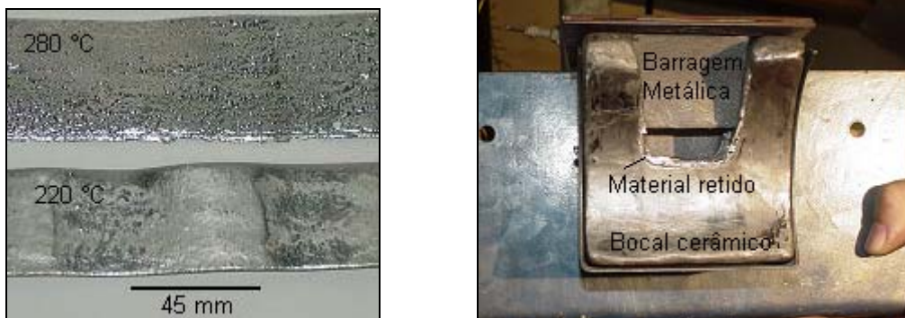
Figura 4. Comparação do acabamento da superfície voltada para atmosfera da tira semi-sólida para duas temperaturas de processamento como indicadas e o material retido na soleira do bocal cerâmico ( nozzle ) após o ensaio.
