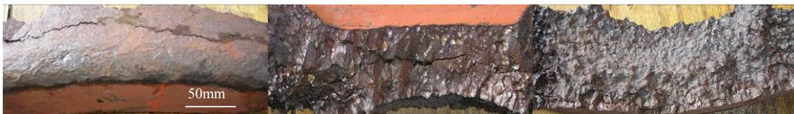
Figura 4 – Fotografias com três vistas da amostra submetida à análise. Esta amostra foi retirada de um dos quatro roletes fraturados. Nota-se o aspecto frágil da fratura, sem nenhuma deformação plástica. Amostra sem ataque, após lavagem com água e tamanho natural.
