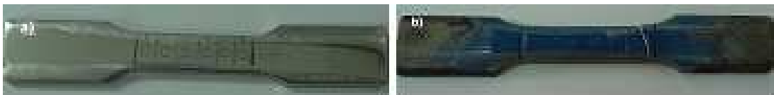
Figura 6 – (a) corpo de prova antes do ensaio sem tratamento térmico, (b) corpo de prova após o tratamento térmico e ensaio de tração (650°C/8h)
