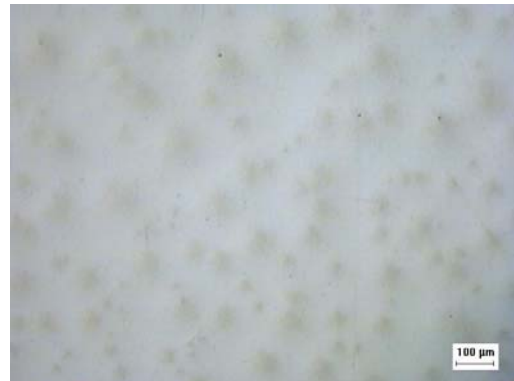
Figura 3. Fotomicrografia da liga Ti6Al4V após ataque térmico sob vácuo.
