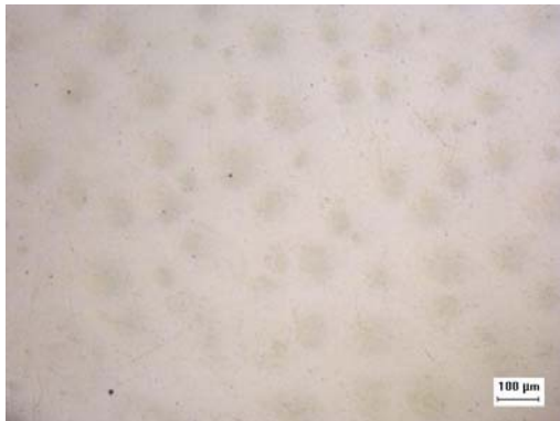
Figura 2. Fotomicrografia da liga Ti6Al4V como recebida.
