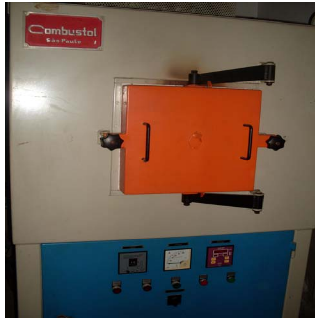
Figura 1. Forno elétrico de mufla (Combustol).
