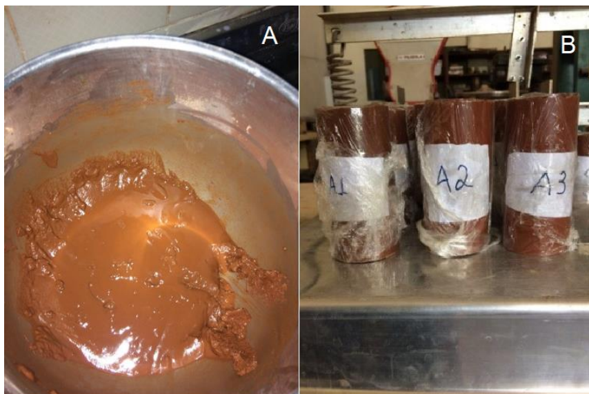
Figura 3. A) Pasta geopolimérica na argamassadeira; B) Corpos de prova retirados dos moldes de PVC e selados com filme plástico.
