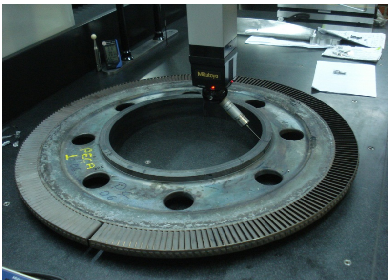
Figura 3: Etapa da engenharia reversa: medição de um disco empalhetado em máquina de medir 3D nas instalações da TGM Turbinas.
