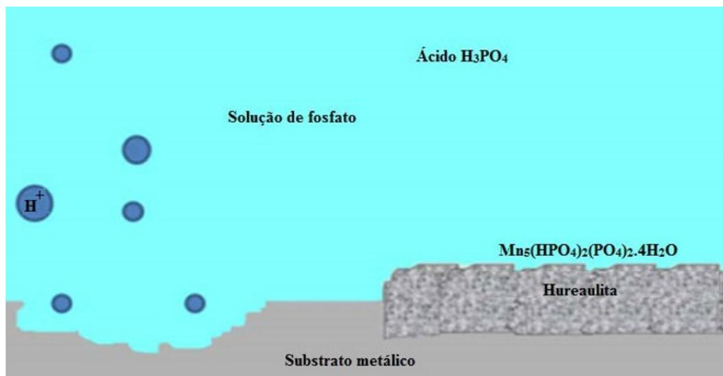
Figura 6. Desenho esquemático do processo químico de fosfatização.
