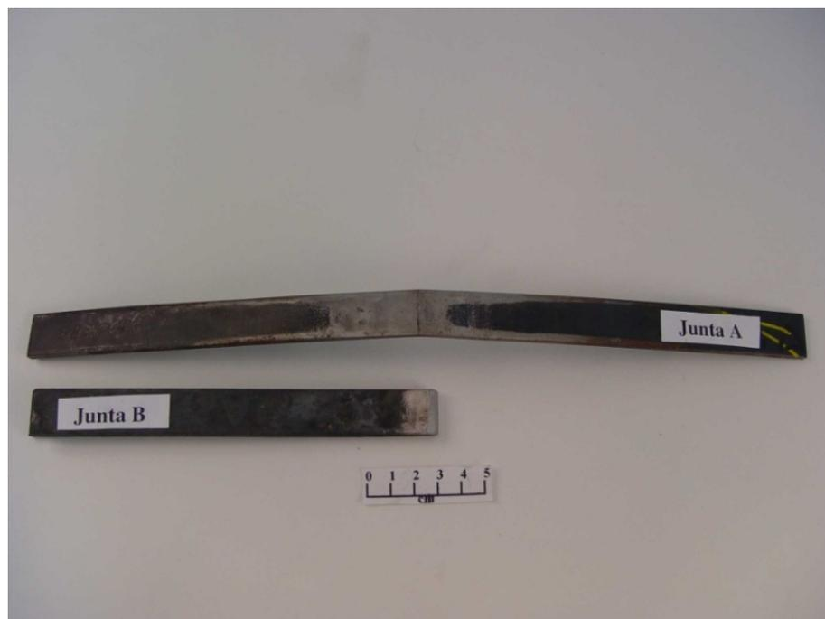
**Figura 7.** Corpos-de-prova das juntas AN e BN após ensaio de dobramento.
