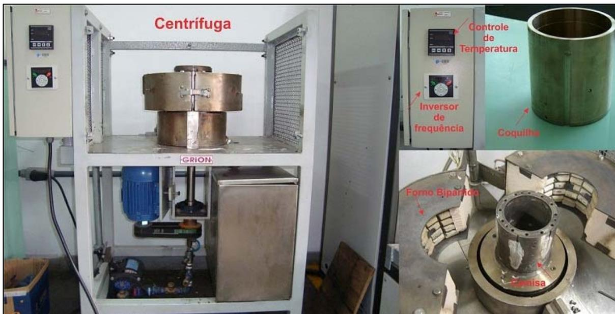
**Figura 2:** Representação da centrífuga laboratorial do Centro de Desenvolvimento de Materiais Metálicos da FEI (CDMatM – FEI).
