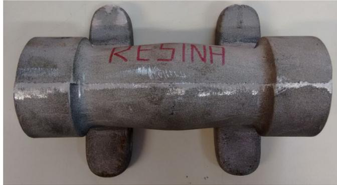
Figura 3 - Vista frontal da peça em alumínio fundida com molde de Areia Artificial com resina de cura a frio [4].
