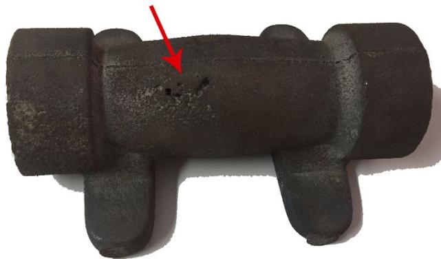
Figura 12 - Inclusão devido ao arraste de areia da região da base de fixação do suporte do eixo de esmeril.
