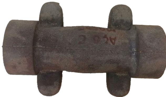
Figura 8 - Peça em aço carbono produzida a partir de molde de areia artificial após corte rebarbação e limpeza.
