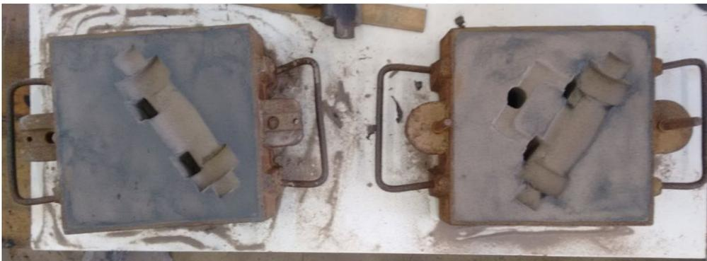
Figura 4 – Partes do molde preparado com a areia artificial.
