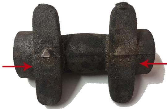
Figura 10- Rechupe apresentado na peça em aço carbono – Molde de areia artificial.
