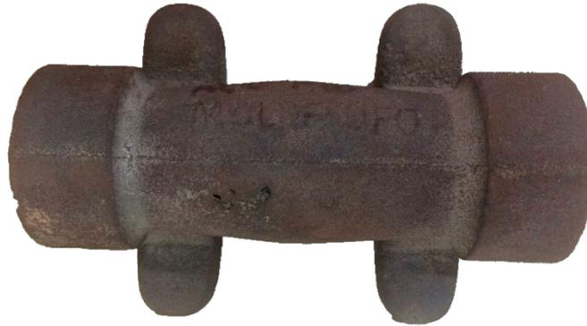
Figura 9 - Peça em aço carbono produzida a partir de molde de areia artificial após corte de canais, rebarbação e limpeza
