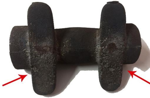
Figura 11 – Acabamento grosseiro na região da base de fixação do suporte de eixo devido a falha na compactação do molde.
