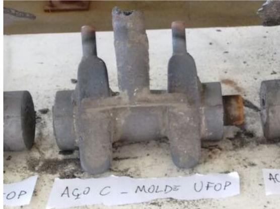
Figura 6 - Peça em aço carbono produzida a partir de molde de areia artificial após desmoldagem.
