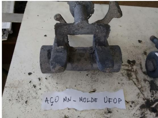
Figura 7 - Peça em aço manganês produzida a partir de molde de Areia Artificial após desmoldagem.
