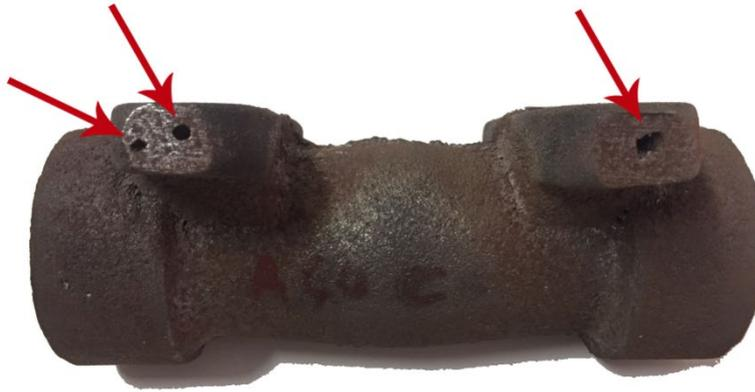
Figura 13 -Presença de rechupe na peça em aço carbono fundida a partir de molde de areia de processo
