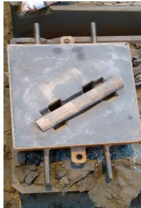
Figura 5 – Parte do molde preparado com a areia de processo já com a colocação do macho.
