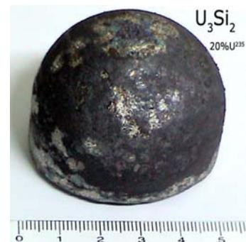
Figura 4. Lingote típico de  $U_3Si_2$
