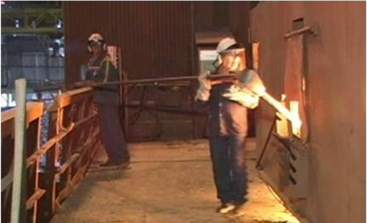
**Figura 2** – Posicionamento manual do dardo durante o vazamento do aço.
