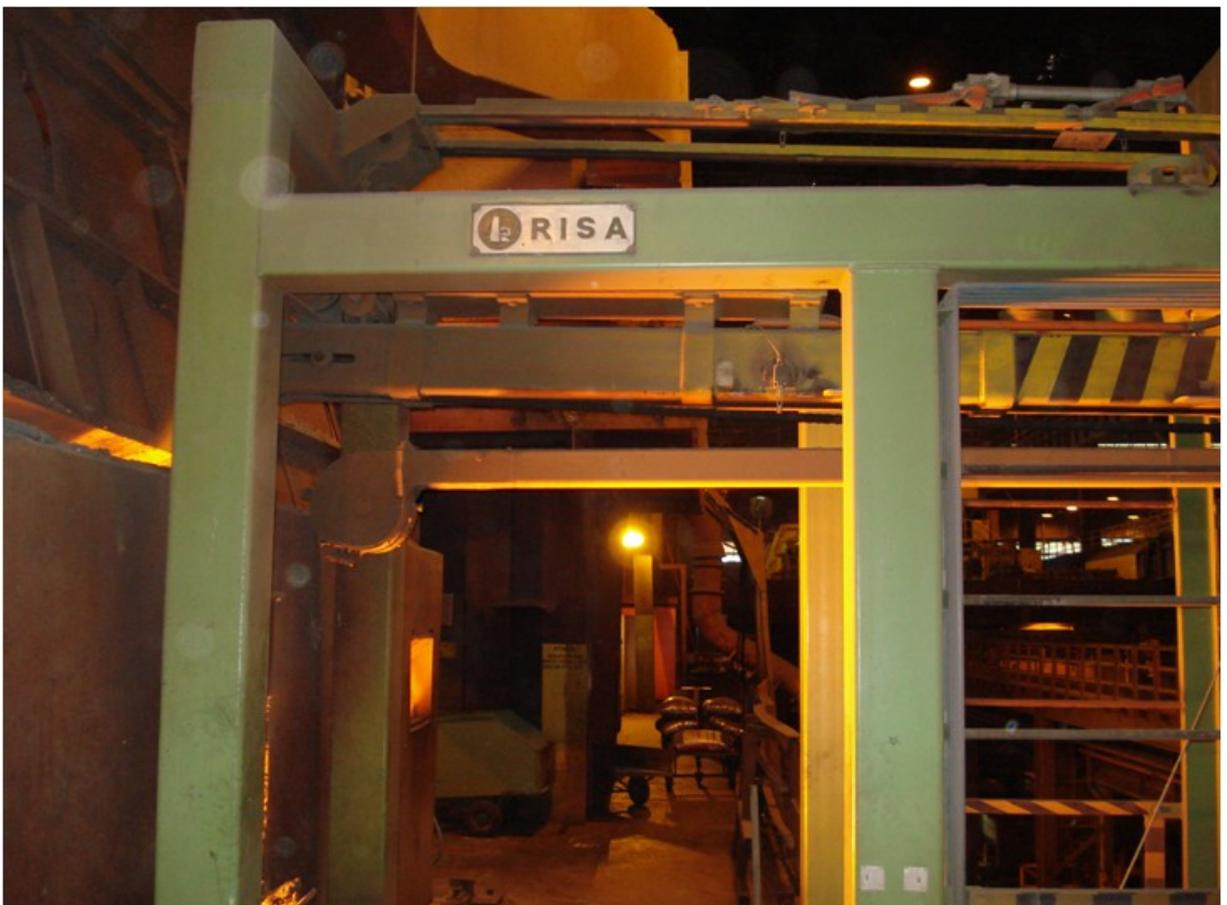
**Figura 3** – Posicionamento automático do dardo durante o vazamento do aço.
