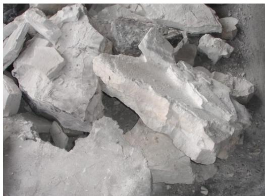
**Figura 3.** Alumina do revestimento de uma cuba P-19.
