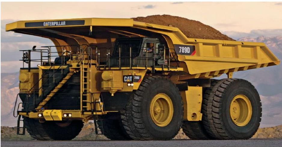
Os motores utilizados nesses caminhões como o da Figura 2.1, são motores diesel, com grandes potências e de grandes dimensões e peso, além de uma alta complexidade. Como exemplo pode-se citar o maior destes caminhões que opera na mina, o CAT789D, que possui um motor diesel marítimo com 16 cilindros e peso seco de aproximadamente 8 toneladas.
