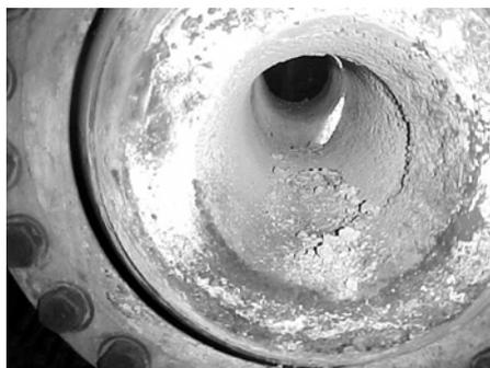
**Figura 14.** Fotografia de um joelho mostrando o canal interno com uma região de desgaste do refratário.
