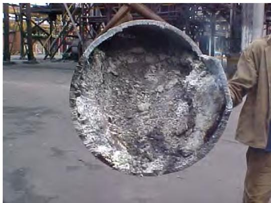
**Figura 17.** Fotografia de tubulação seccionada mostrando a obstrução interna.
