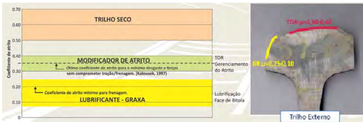
Figura 4. Canto de bitola deve estar com coeficiente entre 0,10 e 0,25 e o Topo entre 0,30 e 0,40. Fonte: (2) Gerenciamento de Atrito – Apresentação realizada pela Ch Vidon no Workshop de Lubrificação de Trilhos da EFVM, Governador Valadares-MG. Julho/2012.
