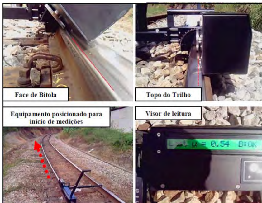
Figura 3. Utilização do tribômetro para a medição do coeficiente de atrito nos trilhos.
