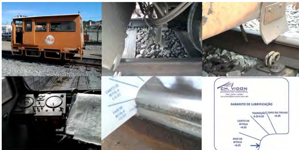
Figura 1. Visão interna e externa do Auto de Linha e gabarito de lubrificação.
