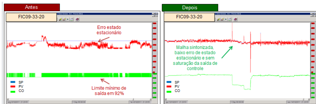
Figura 14. Redução de erro em estado estacionário e saturação na malha de vazão.
