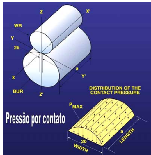
Figura 5 – Esforços atuantes nos cilindros durante laminação – Forças de Hertz
