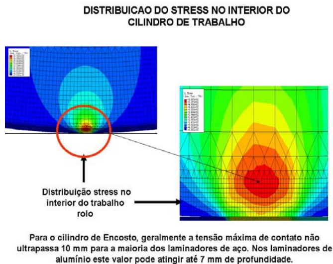
Figura 5 – Esforços atuantes nos cilindros durante laminação – Forças de Hertz
