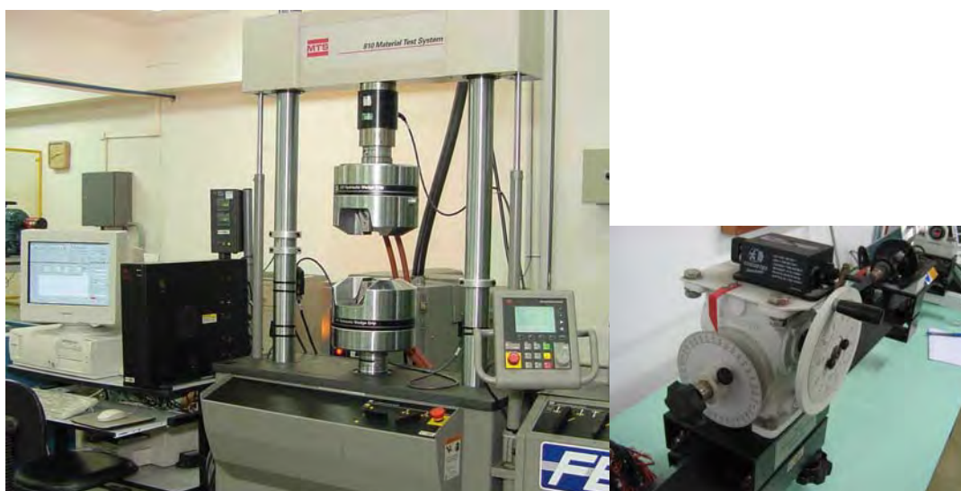
Figura 6: Máquina universal de ensaios MTS utilizada na realização dos ensaios de tração, com capacidade de carga de 250kN (Esquerda). Torquímetro (Direita) (Laboratório de Materiais – Centro Universitário da FEI).
