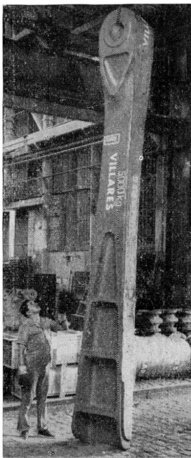
Fig. 7 — Peça de soleira do cadaste da hélice, fundida. No retângulo branco encontram-se os carimbos de aprovação do Lloyd's Register.
