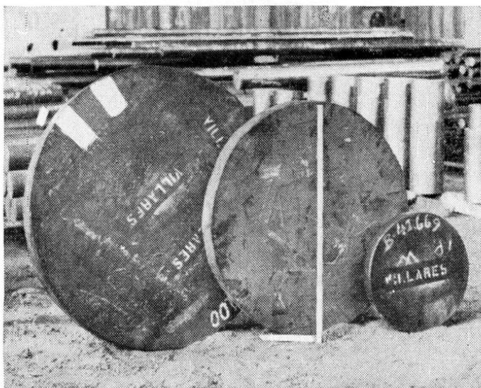
Fig. 3 — Discos forjados de aço ferramenta, medindo o da esquerda 1.200 mm de diâmetro e 150 mm de espessura, pesando 1.350 kg.
