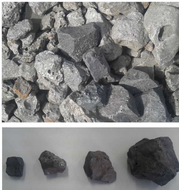
Figura 5. Presença de escória na liga FeCr a/C.
