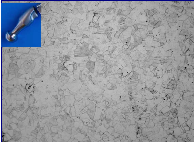
Figura 4 . Microestrutura da cabeça. Ataque: solução com 35 ml de HCl, 30 ml glicerol e 10 ml de HNO 3 . Aumento: 200 X
