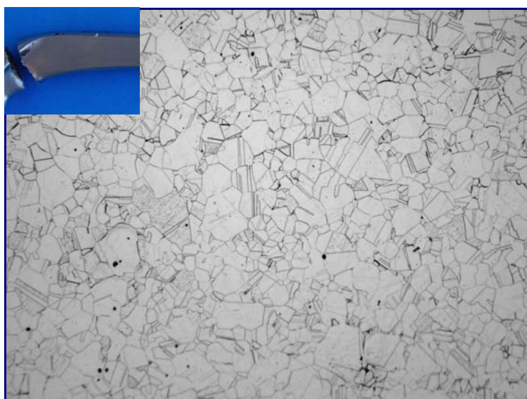
Figura 3 . Microestrutura da haste. Ataque: solução com 35 ml de HCl, 30 ml glicerol e 10 ml de HNO 3 . Aumento: 200 X
