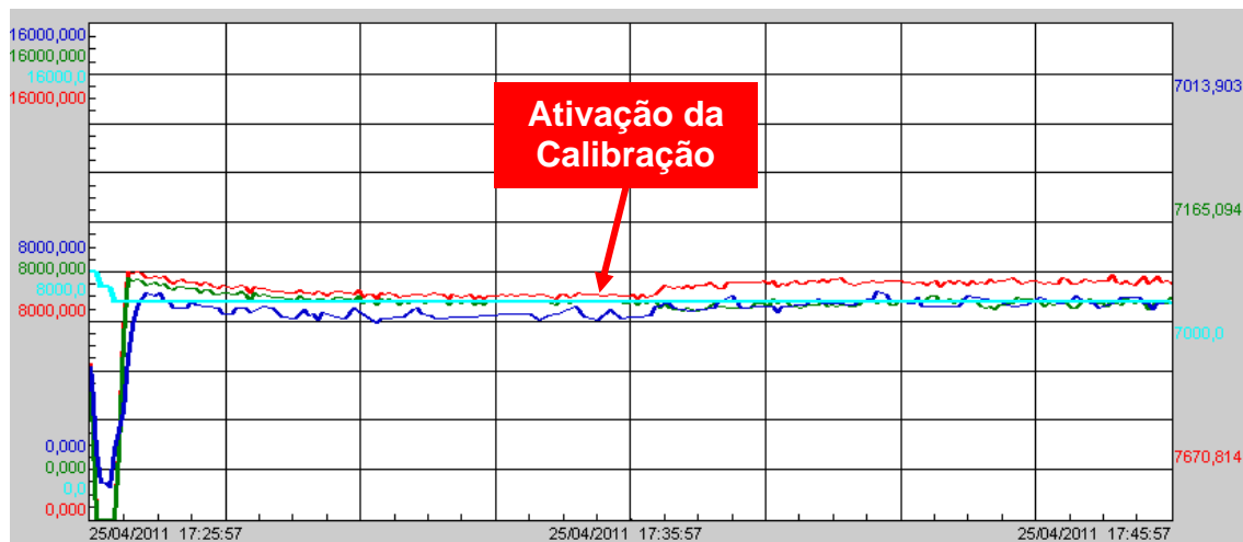
Figura 6 – Comparativo do fluxo real (Azul) X Fluxo estimado (Vermelho) X Fluxo estimado corrigido (Verde).
