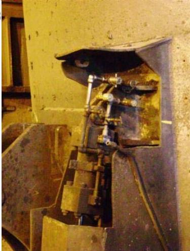
**Figura 2:** Detalhe do mecanismo de cilindro da panela de aço.
