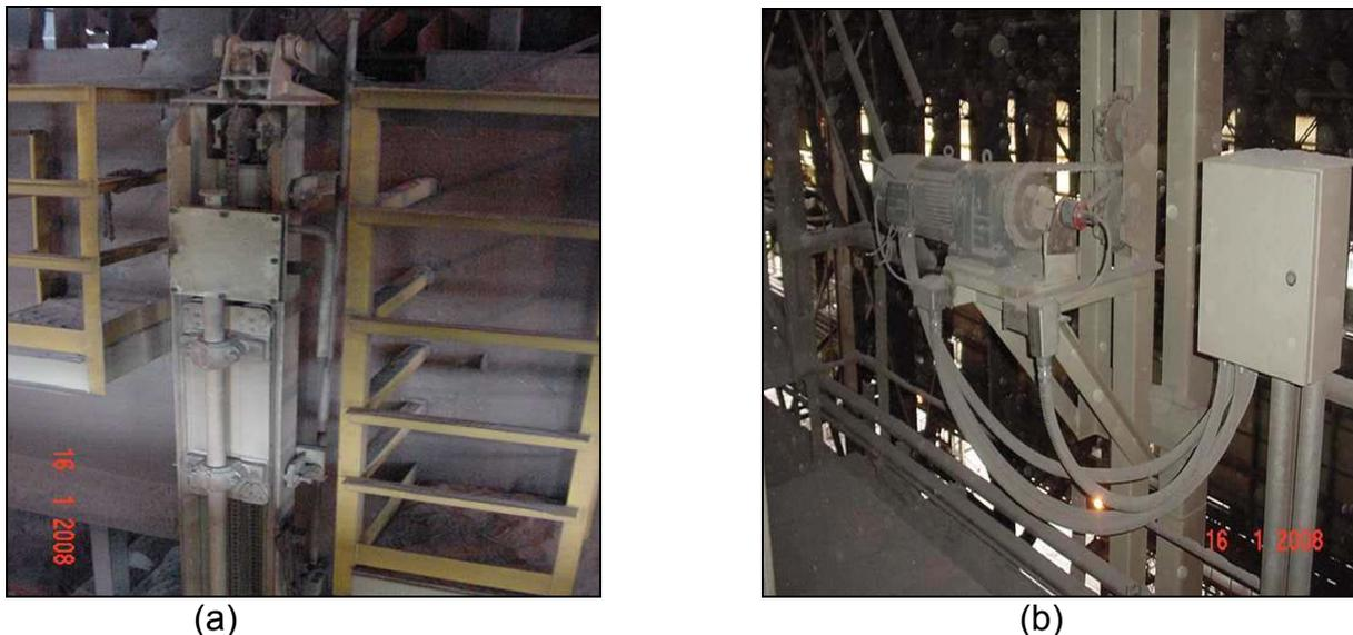
Figura 2 – Ilustração do carro da lança (a) e do moto redutor de acionamento da lança (b).
