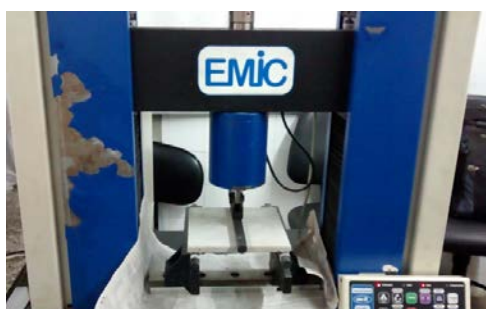
Figura 4. Ensaio de resistência à flexão.
