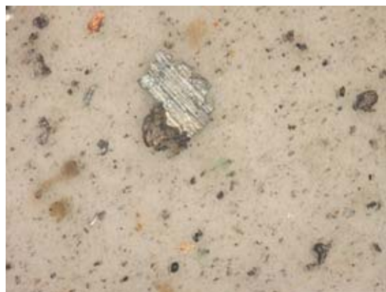
Figura 3. Análise microscópica da Entrada do Filtro Absoluto – Zoom 500x
