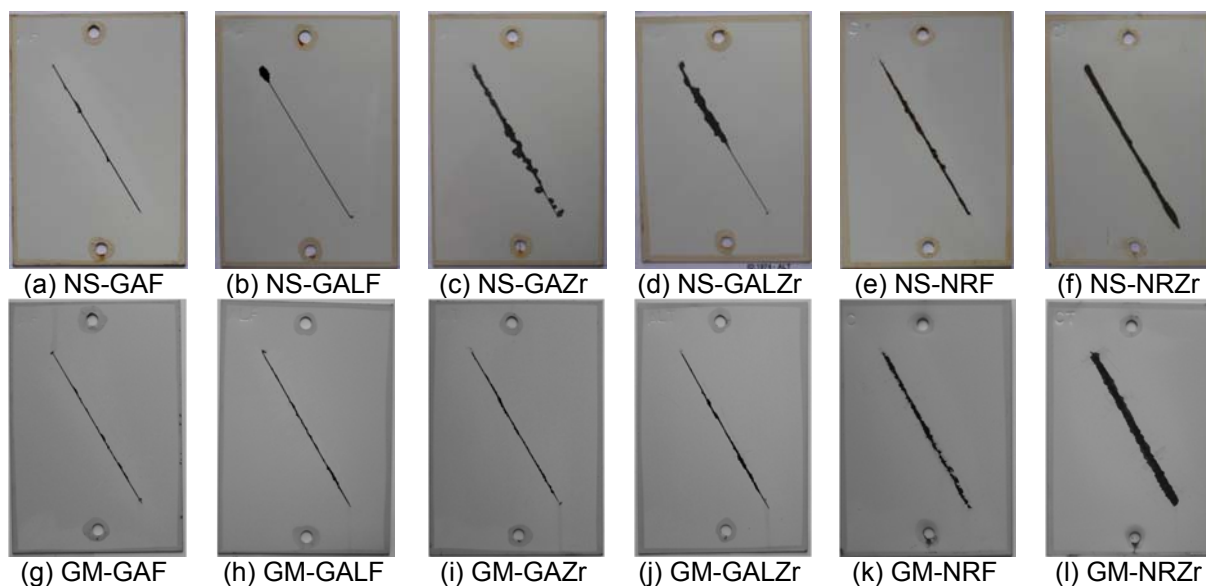
Figura 7. Aspecto dos aços após exposição aos testes de corrosão.
