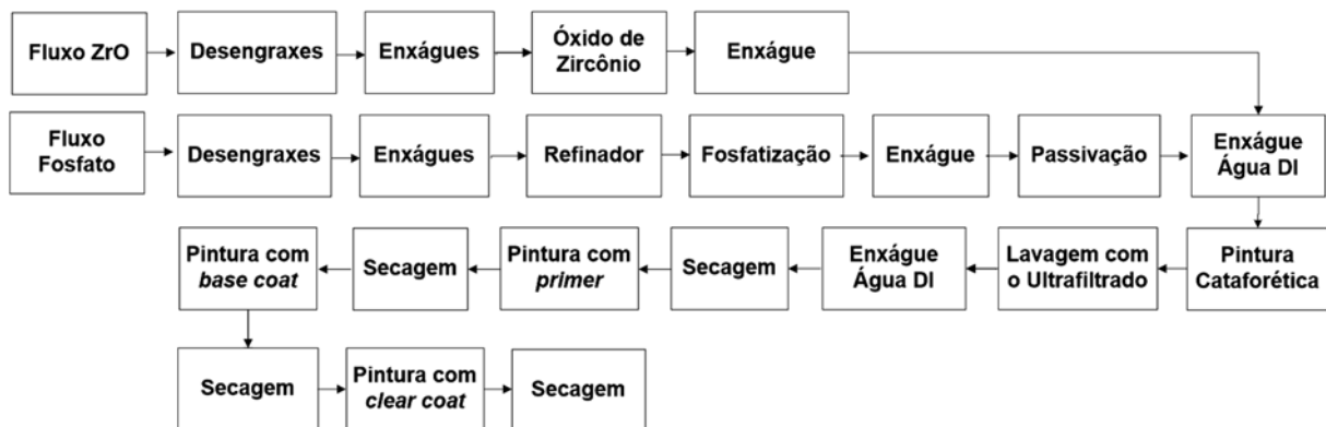
Figura 2. Diagrama esquemático do processo de pré-tratamento e pintura dos aços.
