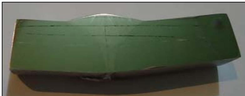
Figura 1. Macrografia do aço inoxidável austenítico AISI 347 soldado.
