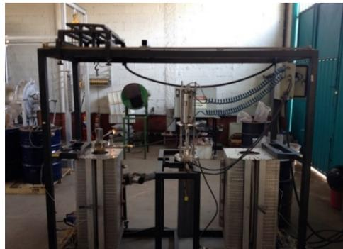
**Figura 5.**–Forno FORTLAB modelo FTRED-1000/CLP utilizado na realização dos testes de RI.
