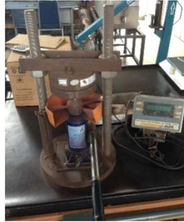
**Figura 4.** Máquina utilizada para determinação da resistência à compressão das pelotas
