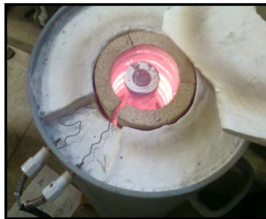
Figura 2. Forno vertical refrigerado a água utilizado no processo de solidificação.
