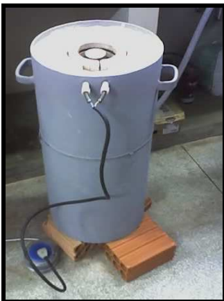
Figura 2. Forno vertical refrigerado a água utilizado no processo de solidificação.
