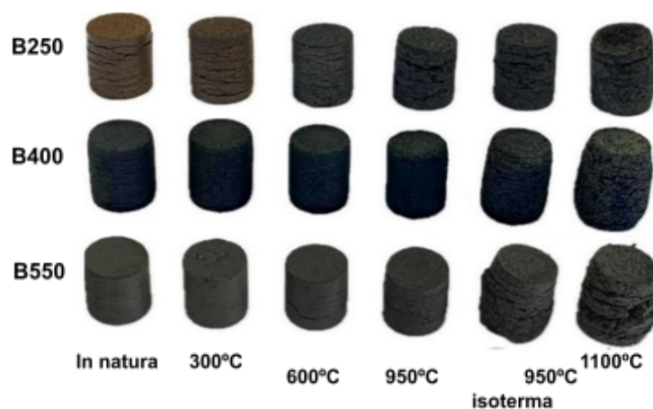
Figura 9. Aspecto visual dos briquetes in natura e após ensaios interrompidos.
