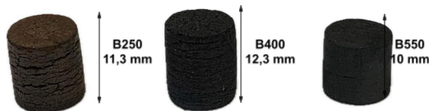
Figura 2. Briquetes autorredutores produzidos com biomassa pirolisada a 250, 400 e 550°C.
