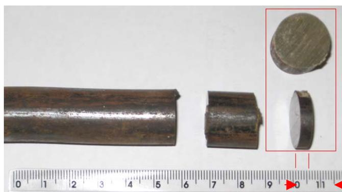
**Figura 1.** Representação esquemática do procedimento de retirada das amostras a partir da barra: dentro do retângulo pode-se ver a amostra que foi submetida ao tratamento térmico e posterior caracterização.
