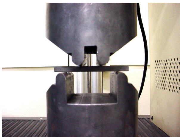
Figura 1. Dispositivo utilizado para o ensaio de flexão em quatro pontos.
