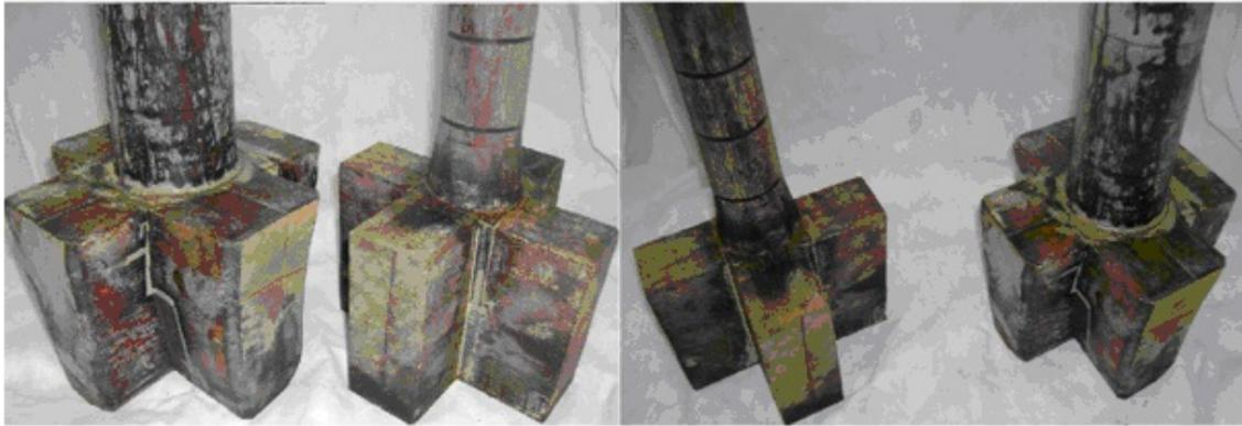
Figura 7– Tipo de agitadores mecânicos: a) tipo curvo (A); b) tipo quadrado (B).
