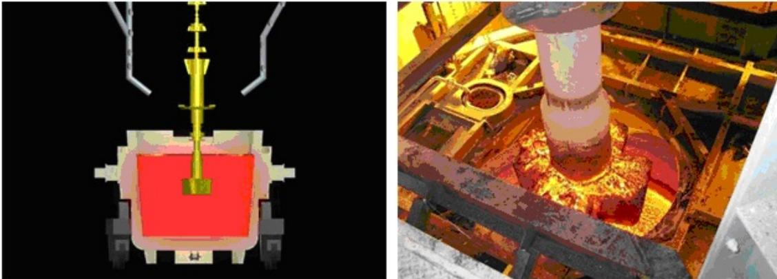
Figura 1- Vista de uma instalação KR para dessulfuração do gusa.
