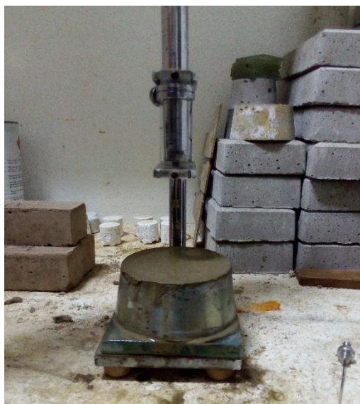
Figura 1. Execução do ensaio para determinação dos tempos de pega
